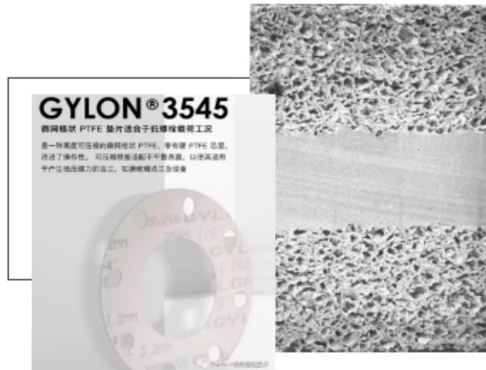
在 1994 年 Garlock 为低载荷工况应用推出了型号 3545 型 GYLON®垫片，用于被腐蚀的、翘曲的和波浪状的法兰。3545 型 GYLON®非常柔软，由可压缩的外层和硬的 PTFE 内芯组成，是适合于需要硬质材料工况却难以密封的管道系统、阀和法兰的理想垫片材料，对于法兰面高度不平整或者受损的法兰面有很强的补偿作用。此外，Garlock 克服了工艺难题，将难分散的石墨材料成功均匀地分散到 PTFE 结构中得到了 3530 型 GYLON®。3530 型 GYLON®大幅度降低 PTFE 的孔隙率，其材料非常致密且耐受绝大部分化学品，解决了易腐蚀且易渗透的氢氟酸密封难题，为无机氟化工的蓬勃发展保驾护航。
