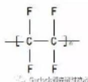
PTFE 相对分子质量较大,低的为数十万,高的达一千万以上,一般为数百万(聚合度在  $10^4$  数量级,而聚乙烯仅在  $10^3$ )。PTFE 是长链结构的高分子树脂,在长时间连续载荷作用下会发生塑性变形(蠕变),这给它的应用带来一定的限制。如当 PTFE 用作密封垫片时,为密封严密而把螺栓拧得很紧,但更易使垫片产生“冷流”(及蠕变)导致密封垫片被压扁。采用切削工艺生产的 PTFE 产品,其切削的痕迹让初始密封变得困难,同时 PTFE 冷流问题容易引起介质泄漏并导致过快的密封失效,温度/压力循环也将加快垫片的应力松弛进而引起垫片吹出。下左图为 PTFE 垫片初始安装时的受力示意图,下右图为一段时间后法兰垫片上的受力示意图。
