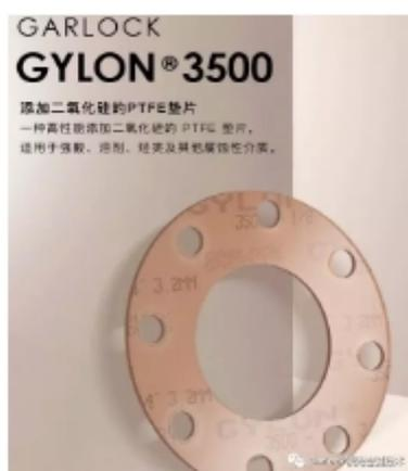
从一个个的 PTFE 大分子到 GYLON®构重组性的改性 PTFE 垫片成品，其制造工艺复杂且要求高。GYLON®采用独特的制造工艺，通过液态的充分搅拌，将独有的 PTFE 分散乳液与填充物在分子级别充分搅拌，通过专有的辊压系统反复压延后得到均匀结构的板材，此板材经过短时间的高温烧结，所含液态溶剂被 100%挥发回收，半成品成功烧结成强度均一的板材成品，在性能上体现为各向同性。由于均匀添加了无机物微颗粒，GYLON®密封材料拥有高度致密的结构和均一优异的性能，保持了卓越的抗化学品性和很好的抗吹出能力，解决了普通聚四氟乙烯用于密封易蠕变松弛的难题。
