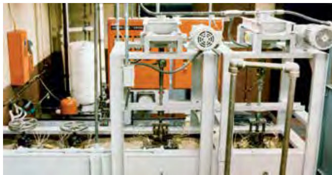
Dispositif d'essais pour les vannes Garlock
