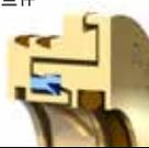
标准法兰件                       | 构造材料：<br>29602：青铜<br>29604：316 SS<br><br>排水口：<br>内侧 1 个<br>外侧 1 个 | IP 66 | 12,000 fpm<br><br>60.9 m/s | ±0.025"<br><br>±0.64 mm | ±0.020"<br><br>±0.51 mm | 0.625" 至<br>10.500"<br><br>15.9 mm 至<br>266.7 mm | 0.700" (0.325" / -.375")<br><br>17.8 mm<br>(8.3 mm / 9.5 mm)  | (≤0.625") : 0.347"<br>(>0.625") : 0.125"<br><br>(≤15.9 mm) : 8.8 mm<br>(≤15.9 mm) : 3.2 mm |
