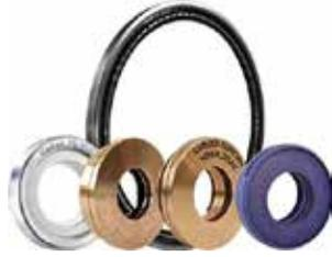
动密封是密封与设备的接触面有相对运动的密封形式，一般按密封原理分为接触型与非接触型密封两大类；按照设备载荷的方式分为一般载荷密封和重载密封。Garlock 在满足一般工况的前提下，更多关注重载、高速等苛刻工况，优势产品包括重载油封、轴承隔离器、高性能改性聚四氟乙烯轴封。
