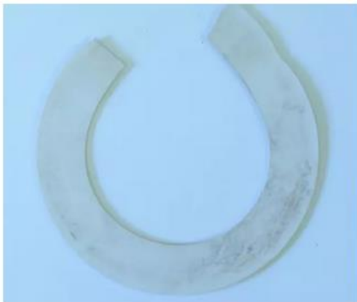
图5 压缩载荷过低引起垫片吹出 图6 压缩不均匀导致垫片吹出
