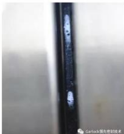
图 3 压制纤维橡胶垫片在鼓泡测试中泄漏
