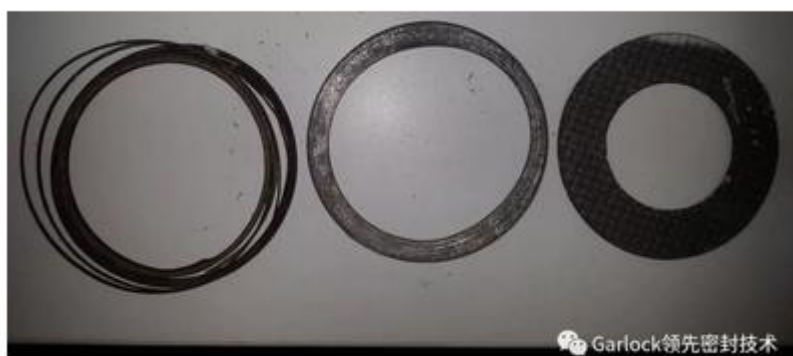
图 2 石墨垫片石墨部分被高温氧化
