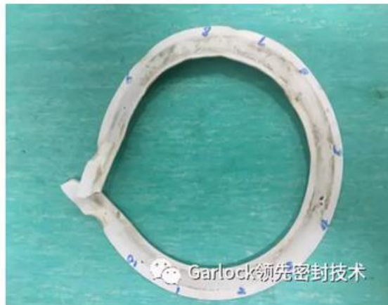
图5 压缩载荷过低引起垫片吹出 图6 压缩不均匀导致垫片吹出
