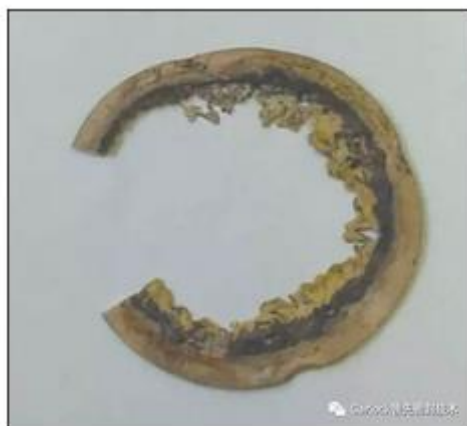
图 1 垫片被单体介质腐蚀发生爆米花效应
