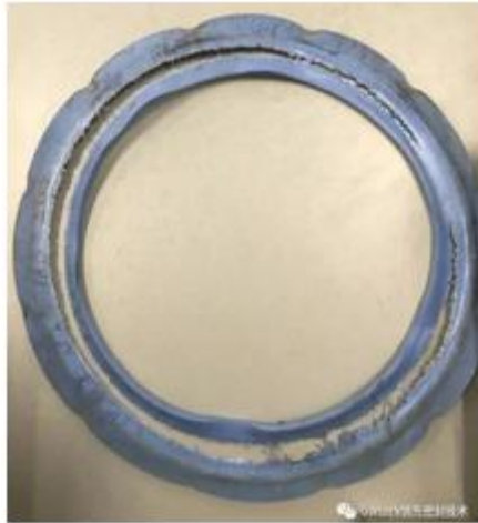
图4 垫片过度压缩导致垫片压溃
