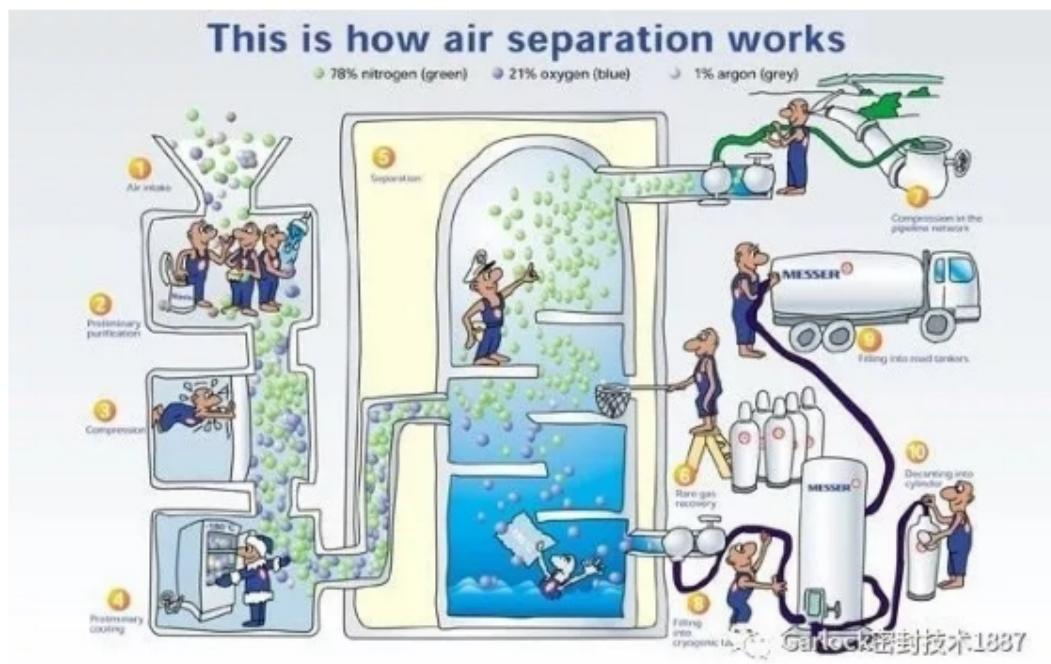
图 1：空气分离的工作原理
